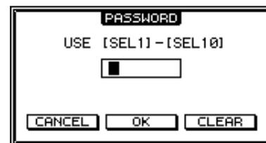
Inserire una password a quattro cifre utilizzando i pulsanti canale 1-10 [SEL] (il pulsante del canale 10 [SEL] corrisponde allo "0"). I caratteri della password vengono visualizzati come asterischi. Spostare il cursore sul pulsante OK, quindi premere [ENTER] per arrivare il blocco delle operazioni. La password predefinita di fabbrica è "1234".
